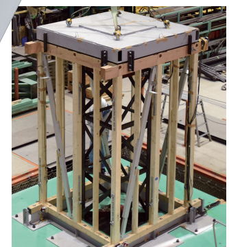
2階建実棟想定荷重を載せた一坪実寸大の「ブレースリー®」試験体と「木筋かい(45×90)」試験体に、三次元振動台によるJMA神戸波震度7×125%を再現した繰り返しの加震実験を行なった。
